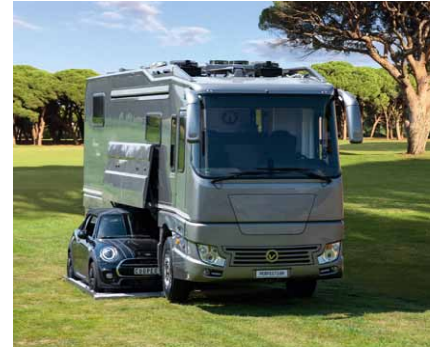
Das Mini-Cabrio ist sicher ohne Verzurren zwischen den Rädern des Busfahrwerks verstaut und lässt sich auf Knopfdruck ausparken
